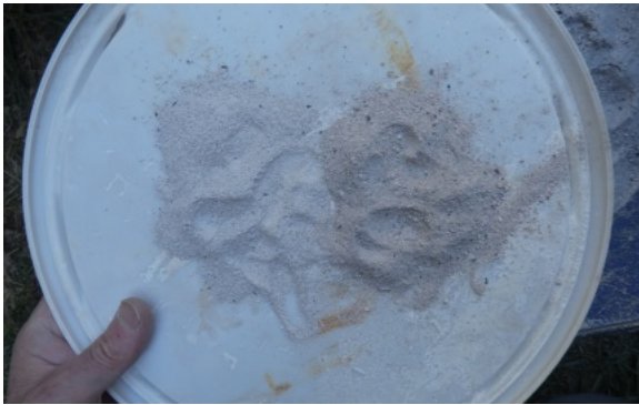
Comparaison du plâtre du plâtrier et plâtre obtenu après cuisson dans le four à griya. Photo Maisons Paysannes des Pays de Savoie © 2019.
