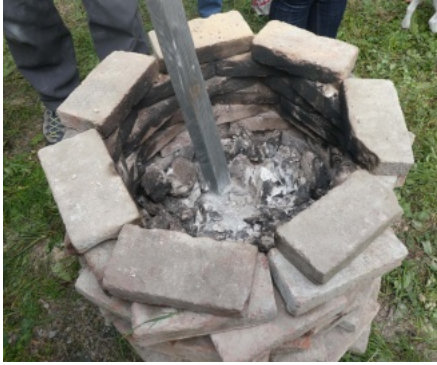
Test de cuisson du gypse à l'aide d'un piquet. Photo Maisons Paysannes des Pays de Savoie © 2019.
