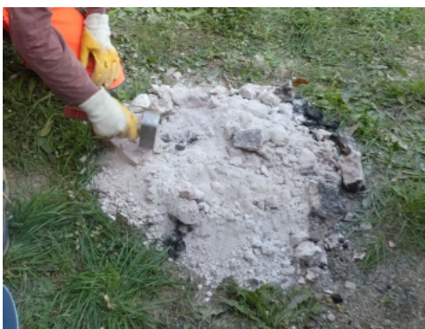
Broyage des morceaux de gypse restant après démontage du four. Photo Maisons Paysannes des Pays de Savoie © 2019.
