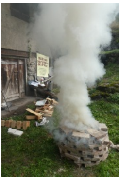
Cuisson du gypse dans le four. Photo Maisons Paysannes des Pays de Savoie © 2019.
