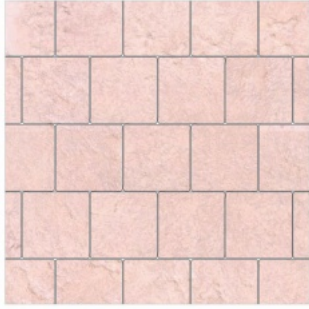
Pose à joints décalés
